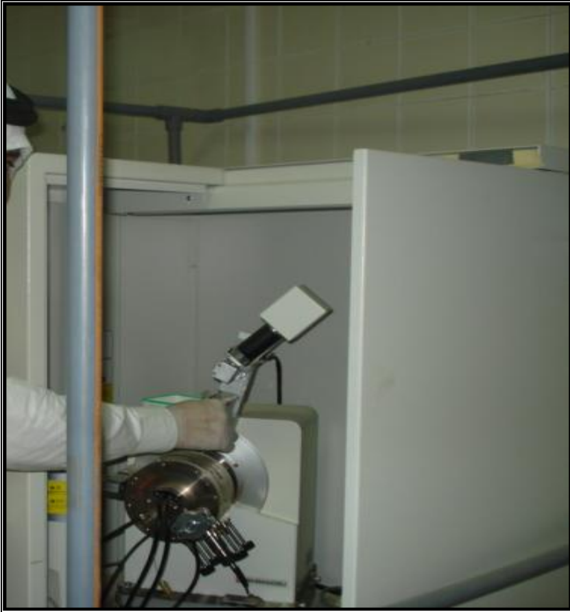
شكل (٢-٤): جهاز ( X-ray Diffraction ) لقياس الحيود على مسحوق العينات.
